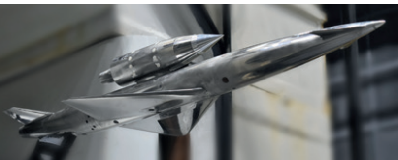
Modellino della configurazione proposta da Rel (Uk) per Mach 5, durante la campagna sperimentale di test aerodinamici nelle gallerie del vento di Incas (Romania)
