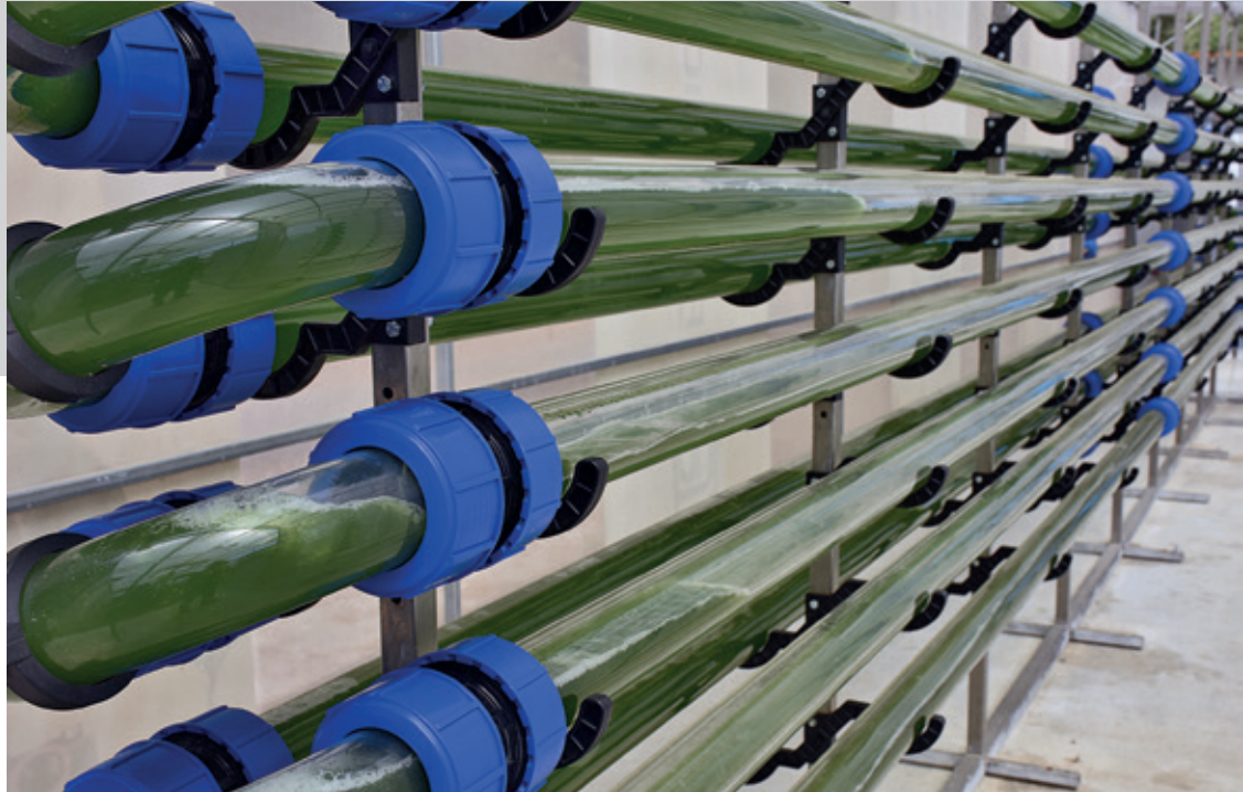
il sistema di Fotobioreattori, sviluppato da Plastica Alfa e Originy per la coltivazione di microalghie
